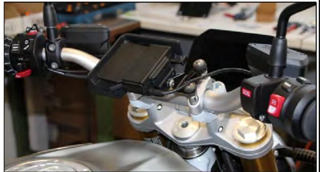
Die Abdeckkappe von der Bremsleitung und den Kunststoffstopfen vom Kupplungszyylinder entfernen.
