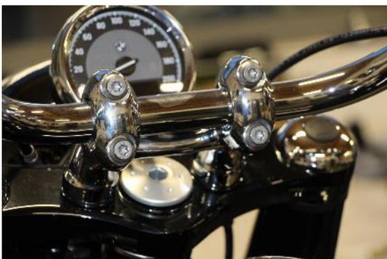
Die beiden Schrauben der originalen Klemmböcke unter der Gabelbrücke ca. fünf Umdrehungen lösen.
