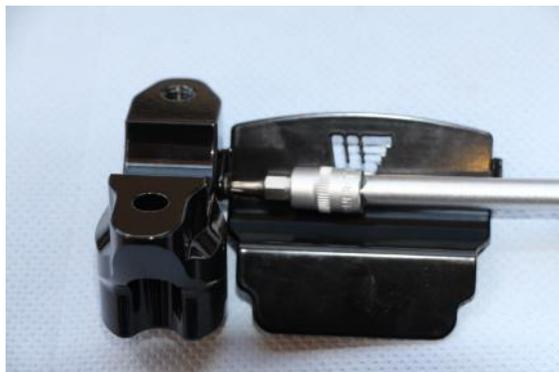
Das Cover mit den beiliegenden Linsenschrauben an die Klemmböcke montieren.
