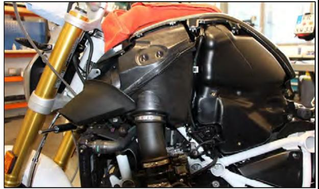
Die drei Kabelbinder der Leitungshalter unter dem Tank lösen.
