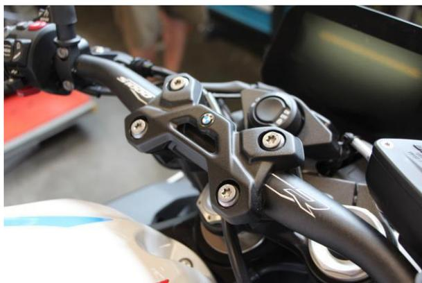
Die vier oberen Klemmböckschrauben lösen und entfernen.
