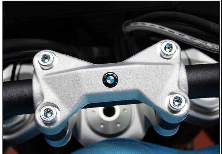
Den Lenker einlegen, Lenker nach der Lenkermarkierung ausrichten und den Lenkerklemmbock auflegen.
