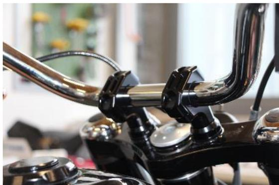
Den Lenker in die Klemmböcke einlegen und leicht fixieren.
