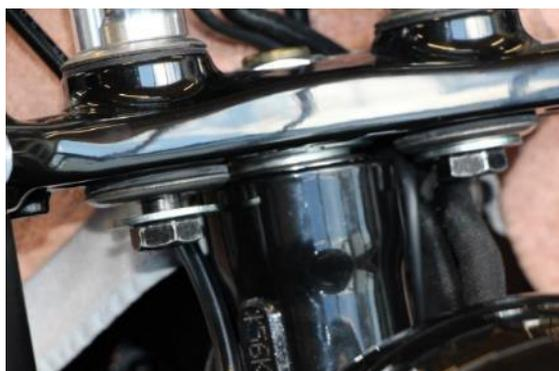
Die beiden Schrauben der originalen Klemmböcke an der Unterseite der Gabelbrücke lösen und den Lenker auf eine Unterlage auf dem Tank ablegen.
