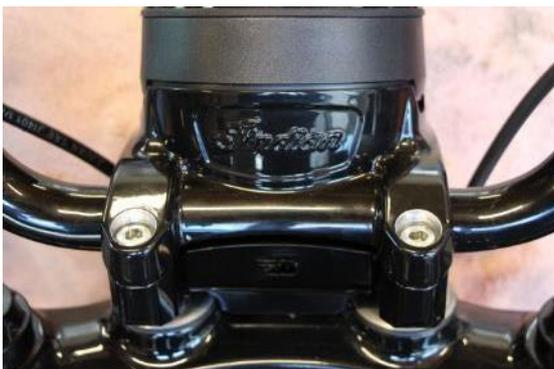
Die beiden oberen Schrauben der originalen Klemmböcke eine halbe Umdrehung lösen.
