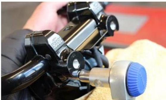
Von unten mit den beiliegenden Zylinderschrauben die Klemmböcke festziehen.
