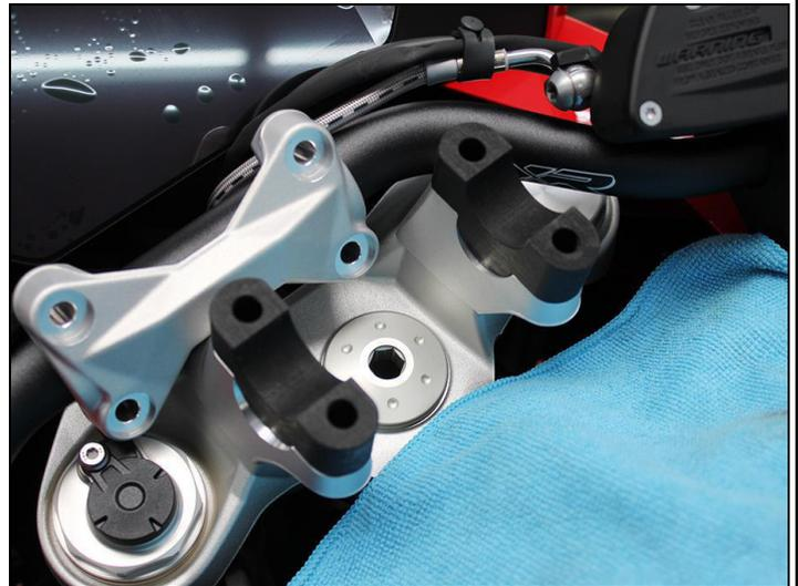
Die gelieferten AC Schnitzer Lenkererhöhungen in die Gabelbrücke / Klemmbochunterteil einlegen.
