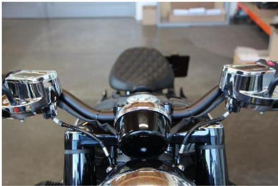
Nach der Endmontage die Freigängigkeit aller Leitungen und Züge kontrollieren und diese nur so weit fixieren, dass Sie bei vollem Lenkeinschlag und über den gesamten Federweg nicht geknickt werden, nicht scheuern und nicht spannen.
