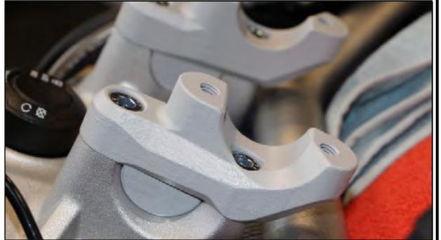
Die vier beiliegenden Befestigungsschrauben mit Schraubensicherung „mittelfest“ benetzen und festziehen.
