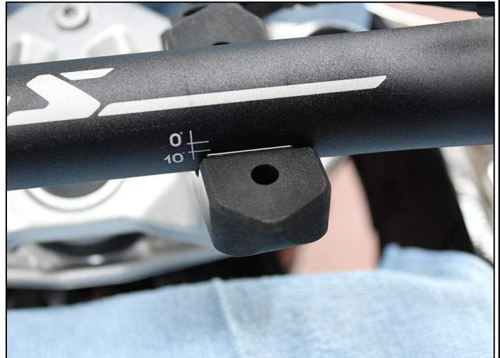
Die Serien Befestigungsschrauben mit Schraubensicherung „mittelfest“ benetzen und eindrehen.
