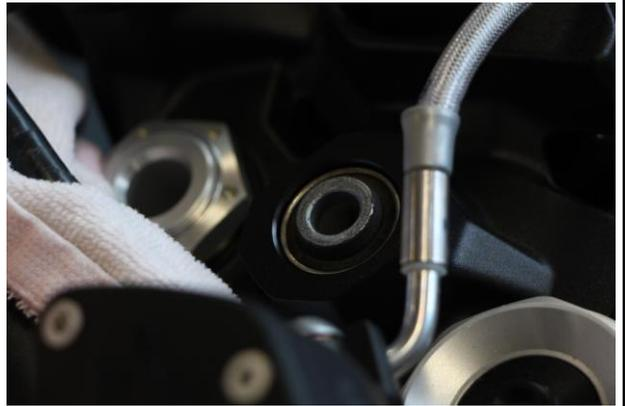
Die Klemmböcke mit den beiliegenden Erhöhungen und den längere Schrauben auf die Gabelbrücke montieren.
