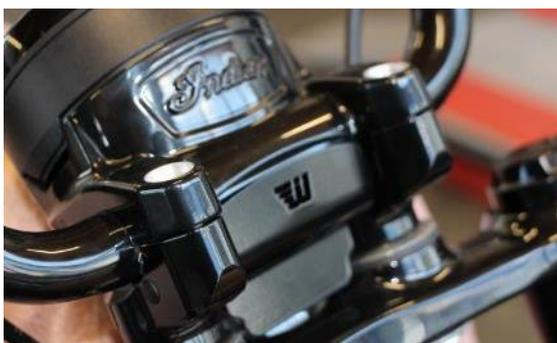
Nach der Endmontage die Freigängigkeit aller Leitungen und Züge kontrollieren und diese nur so weit fixieren, dass Sie bei vollem Lenkeinschlag und über den gesamten Federweg nicht geknickt werden, nicht scheuern und nicht spannen.
