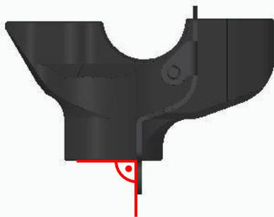
Dabei das Cover im rechten Winkel zur Montagefläche der Klemmböcke ausrichten.
