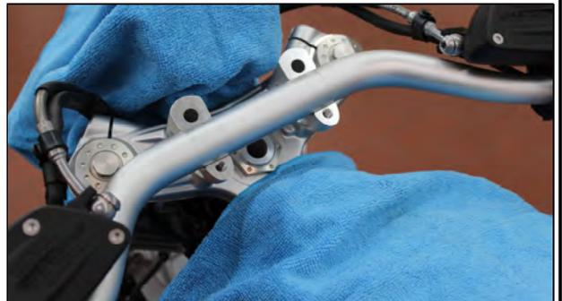
Lenker aus der Gabelbrücke abnehmen und gegen Beschädigungen geschützt ablegen.
