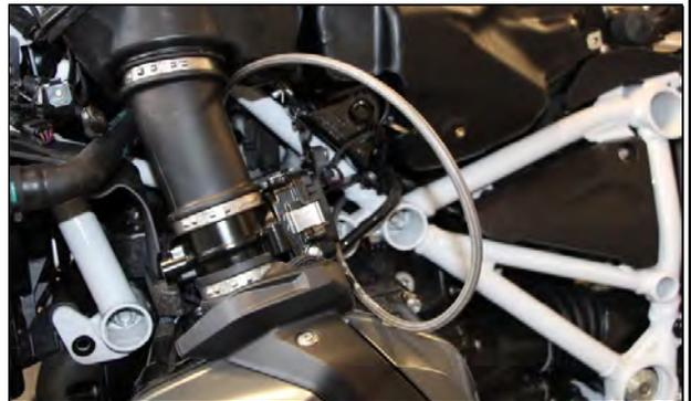
Die Kupplungsleitung so verlegen, dass sie auf kürzestem Weg durch das obere Rahmendreieck (Bild) zum Kupplungszyylinder führt.
