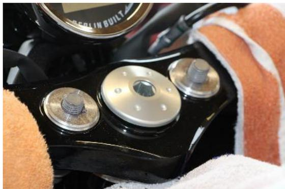
Die beiden Schrauben an der Unterseite der Gabelbrücke komplett lösen.
