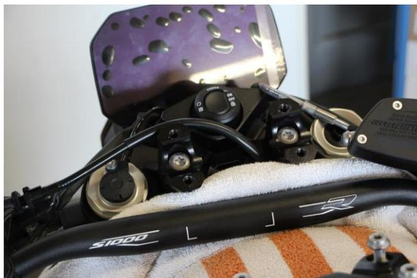
Die zwei Klemmböckschrauben lösen, dabei die Kontermuttern unter der Gabelbrücke gegenhalten.
