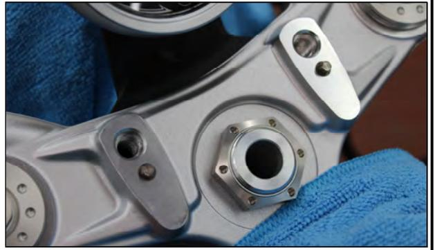
Die gelieferten AC Schnitzer Lenkererhöhungen in die serienmäßigen Zylinderstifte der Gabelbrücke einlegen.
