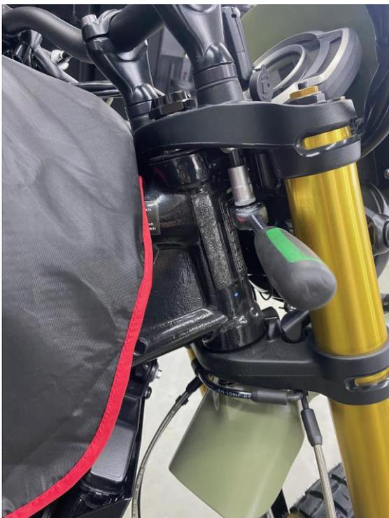
Die beiden Schrauben der Klemmböcke komplett lösen und herausrauben.
