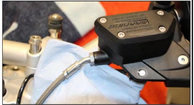
Die Kupplungsflüssigkeit nach Werksangaben aus dem Behälter oder aus dem ganzen System absaugen.
