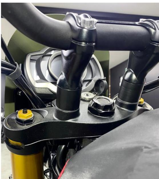
Lenkererhöhung zwischen Gabelbrücke und Klemmböcke setzen
