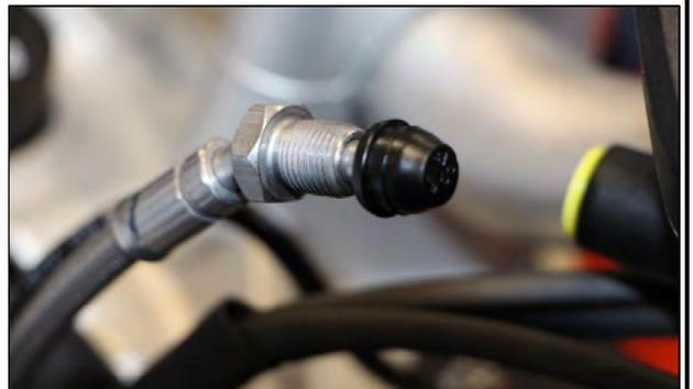
Die Bremsleitung mit der Abdeckkappe verschließen.
