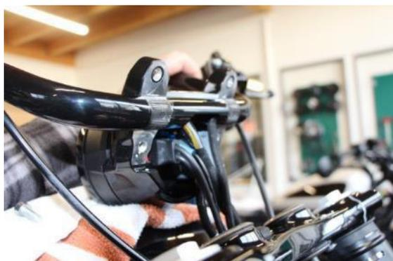
Die originalen Klemmböcke mit Tacho lösen und mit dem Lenker komplett entfernen.
