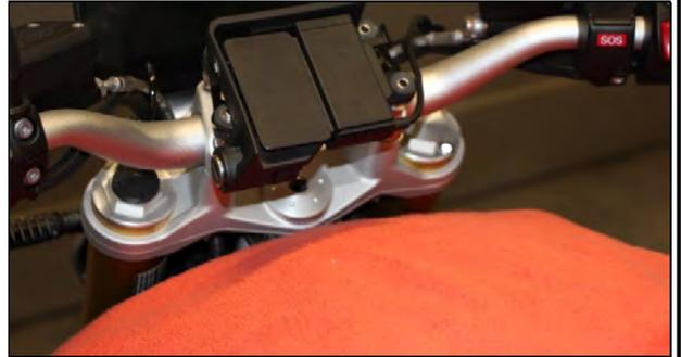
Die Befestigungsschrauben des Halters für das Navigationssystem gegen den Uhrzeigersinn lösen und diesen seitlich aus der Gummiführung entnehmen.
