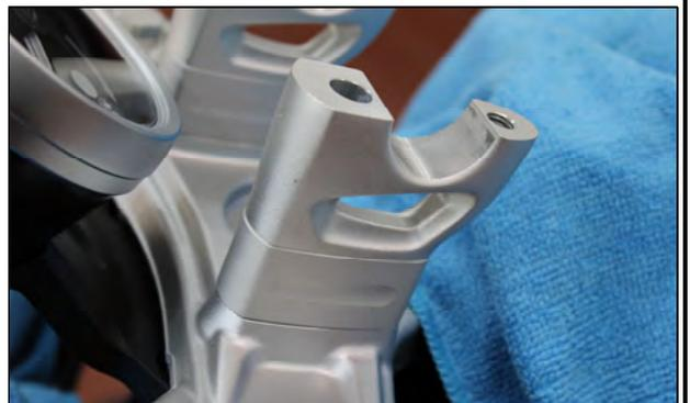
Die beiliegenden Befestigungsschrauben mit Schraubenkleber „mittelfest“ benetzen.
