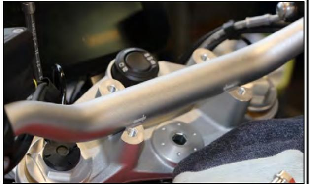
Die gelieferten AC Schnitzer Lenkererhöhungen in die Gabelbrücke einlegen. Dabei die Kennzeichnungen R (rechts) und L (links) auf den Lenkererhöhungen beachten.
