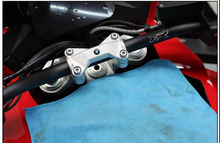
Die vier Befestigungsschrauben des Lenkerklemmbocks gegen den Uhrzeigersinn lösen.
