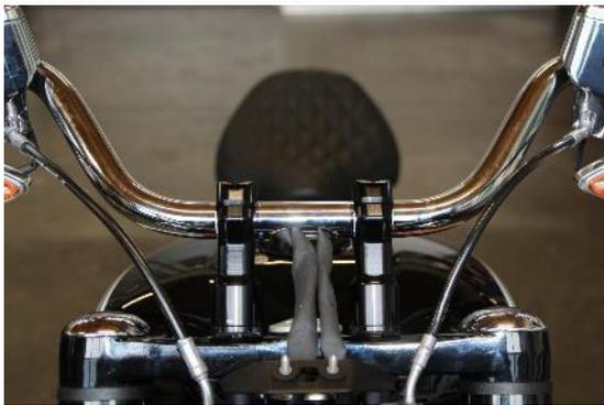
Alle Schrauben mit Schraubensicherungsmittel (mittelfest) und dem vorgegebenen Drehmoment befestigen.
