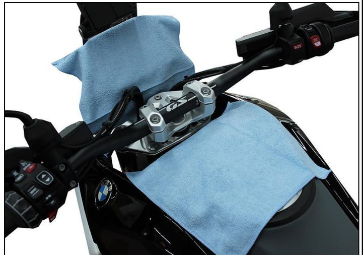
Die vier Befestigungsschrauben der Lenkerklemmböcke gegen den Uhrzeigersinn lösen.
