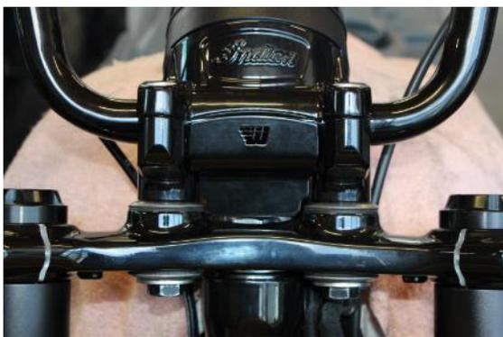
Abschließend die Klemmböcke wieder mit den beiden originalen Schrauben an der Gabelbrücke befestigen.
