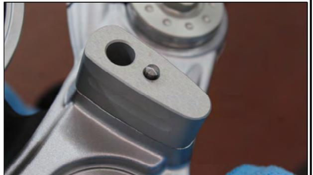
Die originalen Klemmbockunterteile auf die Lenkererhöhung auflegen.
