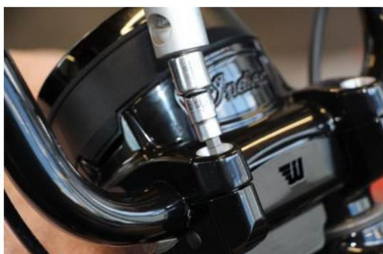
Von oben die neuen Klemmböcke mit den originalen Schrauben mit Lenker und Tacho verschrauben.
