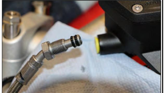
Die Kupplungsleitung von der Kupplungsarmatur lösen.
