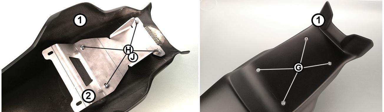
Das Montageblech (2) mit den Senkkopfschrauben (G), den U-Scheiben (H) und den Muttern (J) unter der Sitzbank (1) befestigt. Nur leicht anziehen, damit die eine spätere Ausrichtung bei der Montage möglich bleibt.
