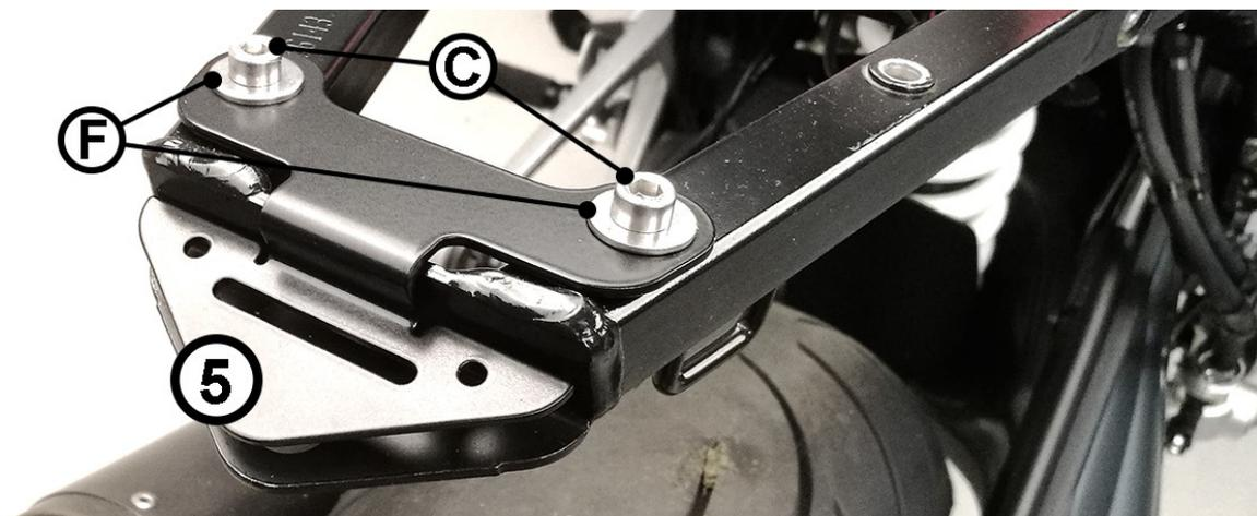
Das Dreiecksblech dient auch als Halter für die hinteren Blinker (Artikel JVB0067 oder JVB0068). Die Blinker sollten mit dem Dreiecksblech verschraubt werden, bevor dieses montiert wird.
