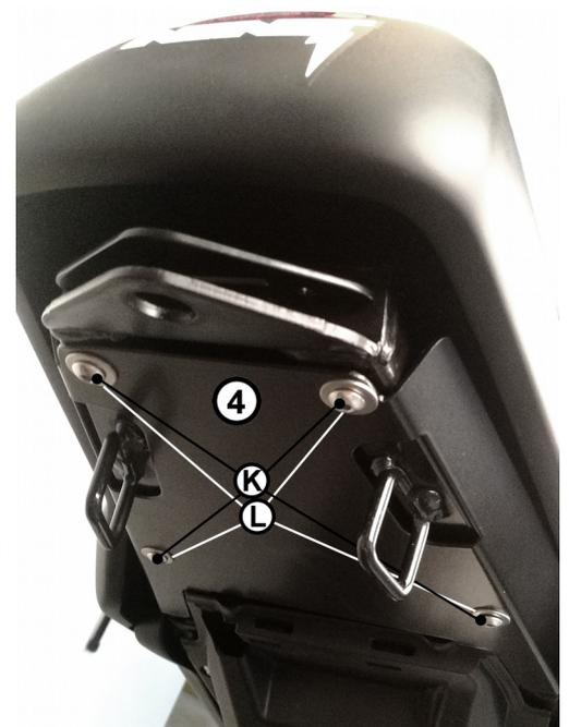
Zuletzt wird der Spritzschutz **(4)** mit den Schrauben **(K)** und den U-Scheiben **(L)** unter der Sitzbank montiert.
