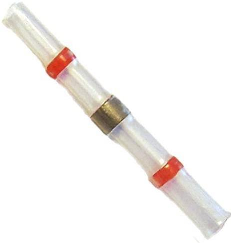
Verbinden Sie beide Kabelstränge mit den beigelegten Lötverbindern. Schieben Sie dazu jeweils zwei Kabelenden in den Lötverbinder und erwärmen Sie diesen mit einem Feuerzeug oder Heißluftföhn.
