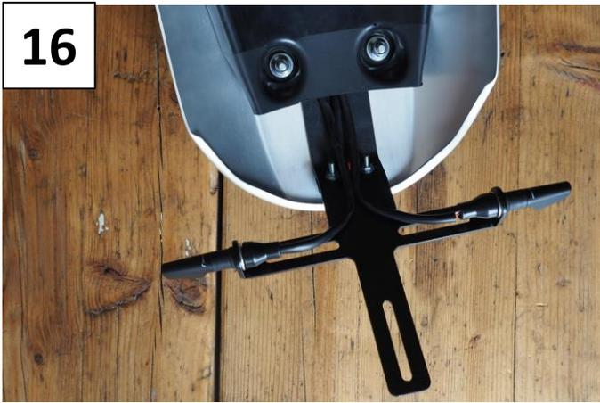
Montieren Sie den Kunststoff-Kotflügel mit dem Aluminium-Kotflügel analog zur Demontage.
