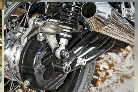
Kunst steckt im Detail: aus dem Vollen gefräste Radnaben, Eigenbau-Schwinge, polierte, klangstarke Edelstahl-Auspuffe
