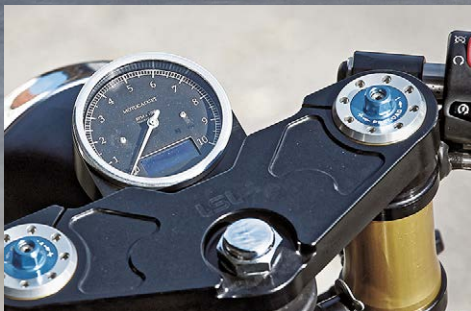
Alles LSL hier: Gabelbrücke und Lenkerstummel nämlich; einstellbare Ölflüssigkeitsgabel und Motogadget-Instrument
