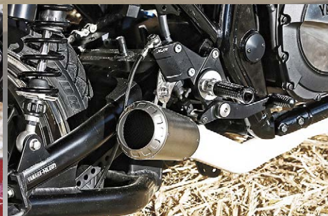
Brüllrohr: keramikbeschichtete Krümmer mit völlig offenem Akrapovic-Schall-„dämpfer“, Racing-Schwinge von Over
