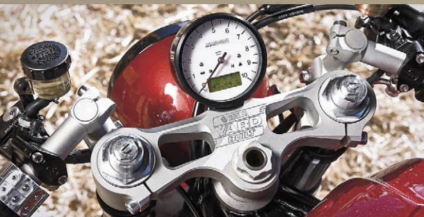
Luftig, leicht, lecker: Motogadget-Instrument, Spezial-Gabelbrückensatz sowie einstellbare Lenkerstummel von BKG
