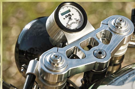
Form, Funktion und Fräskunst. Im Eigenbau-Tacho/Drehzahlmesser steckt auch die integrierte Digital-Zündanlage
