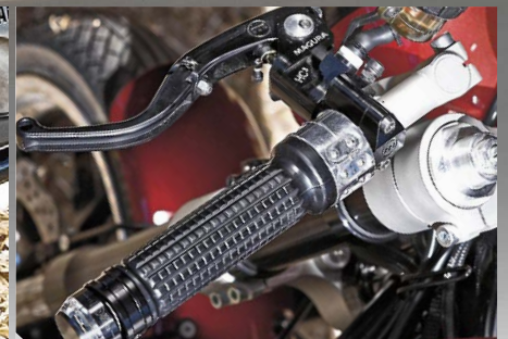
Feinste Ware: radiale Magura HC 3 -Kupplungs- und Bremspumpe, Griffe und „Tastaturen“ von Motogadget
