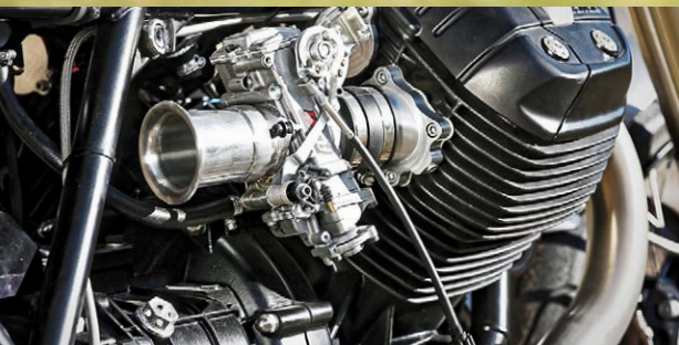
Schnappt nach Luft. Und nach den Knien. Keihins FCR-Flachschieber sind eine Ode an die Mechanik – und eine echte Kraftkur
